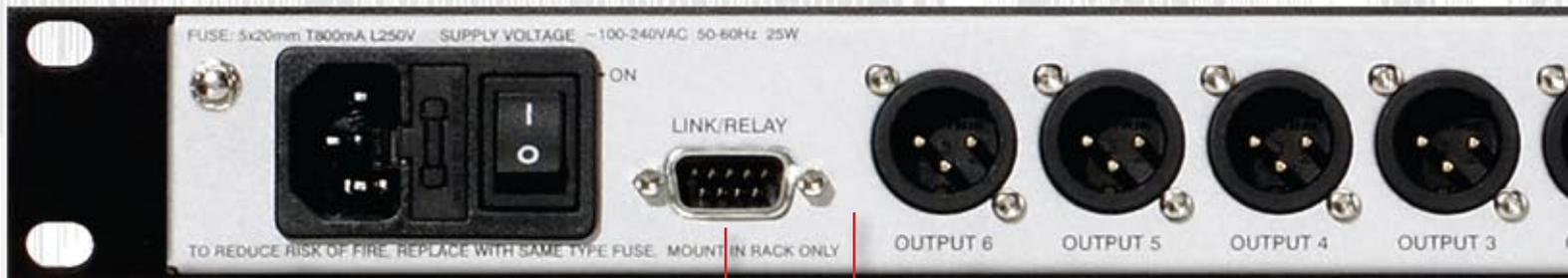
Puerto RS-232 para conexiones Maestro/ Esclavo o para llamar presets GPI
