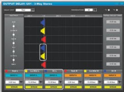
Exclusiva Interfase de Ajuste de Delay – Los usuarios pueden posicionar los componentes del sistema tal y como éstos existen de hecho en el espacio, haciendo posible el mover los dispositivos hacia delante o hacia atrás en el entorno. Múltiples opciones de enlace de canales están disponibles y el tiempo total del delay está siempre desplegado.
